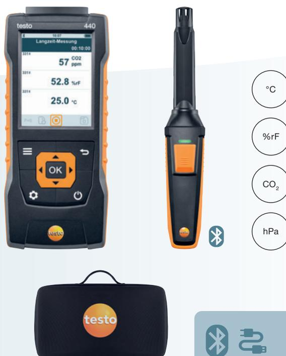
Mit dem testo 440 CO<sub>2</sub>-Set mit Bluetooth® lassen sich alle klimarelevanten Parameter zur Beurteilung der Raumluft kabellos messen und dokumentieren. Das Klima-Messgerät testo 440 erkennt Sonden automatisch und erleichtert durch strukturierte Messmenüs das Einstellen von Klima- und Lüftungsanlagen. An das Messgerät können bis zu 3 Sonden gleichzeitig angeschlossen werden: eine Bluetooth®-Sonde, eine kabelgebundene Sonde sowie ein Temperaturfühler mit Thermoelement Typ K Anschluss.
