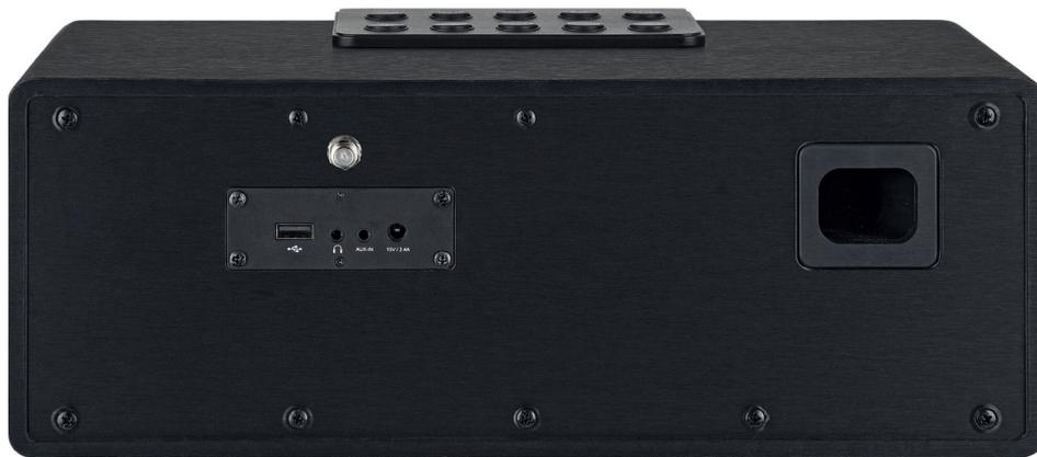
Die USB- und die Kopfhörerbuchse sind auf der Rückseite untergebracht, eine Bassreflexöffnung sorgt beim Sound für ordentlich Tiefgang
