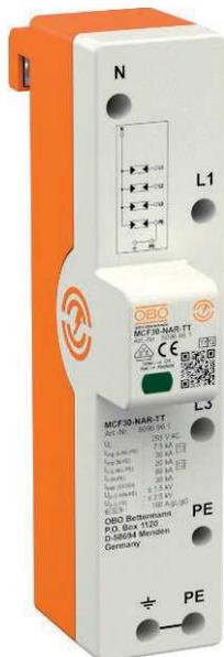
Kombialeiter Typ 1+2 zur Montage auf 40-mm-Sammelschienen, für TN-S- und TT-Systeme
