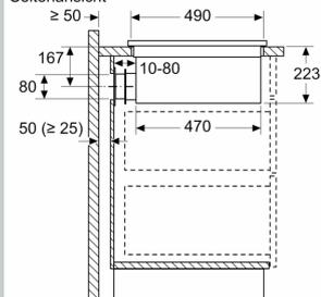
Bei der Installation direkt an einer nicht isolierten Außenwand ( $\mu \geq 0,5 \text{ W/m}^2\text{°C}$ ) empfehlen wir die Verwendung von Konfigurationen mit teilweise oder vollständig kanalisierter Rezirkulation.
