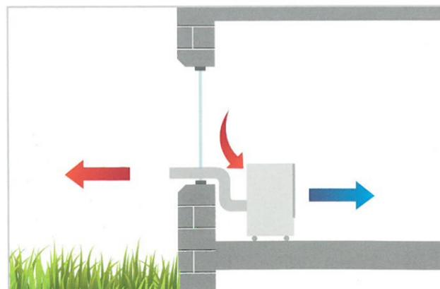
Die angesaugte Luft wird gefiltert, entfeuchtet und gekühlt dem Raum wieder zugeführt. Durch einen flexiblen Abluftschlauch wird die Wärme nach außen geleitet. Dafür brauchen Sie ein Fenster oder eine Tür nur einen Spalt weit zu öffnen. Die Feuchtigkeit wird als verdampftes Kondensat durch den Abluftschlauch nach außen geleitet.
