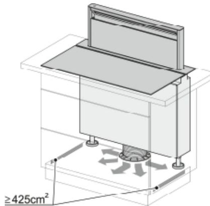
DAD4840, DAD4940 - DUP150, Einbauvariante 1, Skizze, Ausströmpfeile
