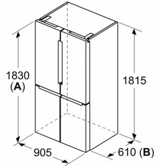
**A:** Front ist von 1830 bis 1847 (bei voll ausgezogenen vorderen Nivellierfüßen) verstellbar
