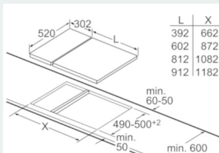
Bei Einbau eines Domino-Elementes direkt neben einer Mulde ist ein Montagesatz (HZ394301) erforderlich.
