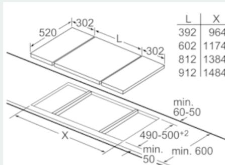
Bei Einbau von zwei Domino-Elementen direkt neben einer Mulde sind zwei Montagesätze (HZ394301) erforderlich.
