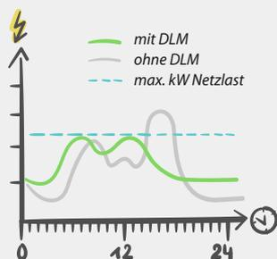
Trotz Spitzenverbraucher ist ein Laden auch bei kleinem Hausanschluss nun realisierbar. Der zur Verfügung stehende Strom wird auf die Ladepunkte verteilt, der Hausanschluss wird nicht überlastet.
