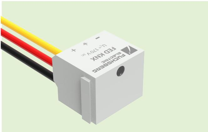
Blitz- und Überspannungsableiter zum Schutz von KNX-Bussystemen. Der Ableiter wird direkt auf den Steckplatz des KNX-BUS-Kopplers aufgesteckt und bietet auch bei geringen Blitzströmen und Überspannungen einen zuverlässigen Schutz.
