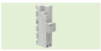
Kombi-Ableiter für Blitzströme Typ 1+2+3 zur Montage auf 40 mm Sammelschienensysteme wird in 3-phasigen Netzsystemen nach Blitzschutzklasse III und IV durch einfaches Aufrasten auf das Schienensystem installiert.
