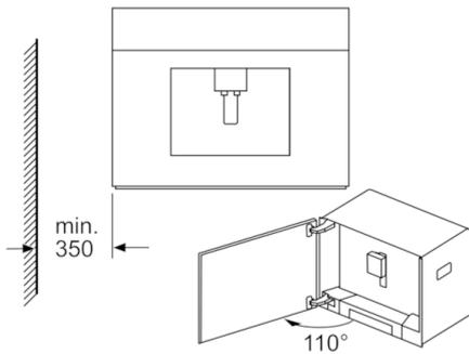
Bei Verwendung der 92° Scharnierbegrenzung (Ersatzteilnr. 00636455) beträgt der Mindestabstand zur Wand nur 100 mm.
