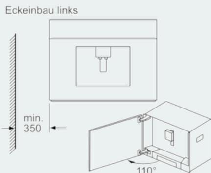
Bei Verwendung der 92° Scharnierbegrenzung (Ersatzteilnr. 00636455) beträgt der Mindestabstand zur Wand nur 100 mm.
