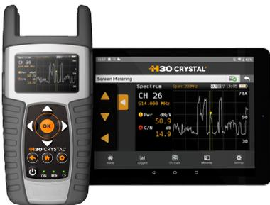
Das Multiscreen-System beim H30+ ermöglicht es, den Bildschirm des Messgeräts auf einem Smartphone oder Tablet anzuzeigen, um das Gerät fernzusteuern oder einfach nur um mit einem größeren Bildschirm zu arbeiten.
