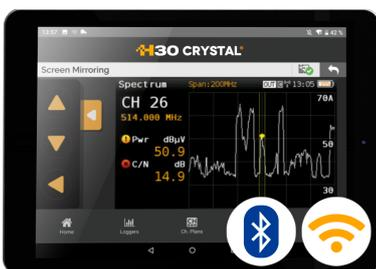
Ausgestattet mit 2,4/5 GHz Wi-Fi und Bluetooth Schnittstelle, ermöglicht das Gerät einen sicheren Zugriff über ein Android-, iOS-Gerät oder PC. Auf diese Weise kann die WEB-Applikation verwendet werden, um so Kanalpläne und Benutzerprofile aufzurufen oder zu bearbeiten, Messungen zu exportieren usw.
