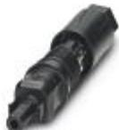
Photovoltaik-Steckverbinder, Artikelfamilie: PV-CF-S, Steckverbinder, Material Gehäuse: PPE, Farbe: schwarz, Polzahl: 0, Aderquerschnitt min.: 6 mm<sup>2</sup>, Aderquerschnitt max.: 16 mm<sup>2</sup>, Bemessungsstrom: 40 A, Anschlussart: Federkraft, Kontaktart: Buchse
