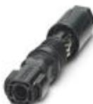
Photovoltaik-Steckverbinder, Artikelfamilie: PV-CM-S, Steckverbinder, Material Gehäuse: PPE, Farbe: schwarz, Polzahl: 0, Aderquerschnitt min.: 6 mm<sup>2</sup>, Aderquerschnitt max.: 16 mm<sup>2</sup>, Bemessungsstrom: 40 A, Anschlussart: Federkraft, Kontaktart: Stift
