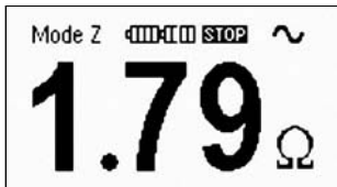
Bild 3.10 Anzeige der Temperaturüberschreitung – Symbol STOP
