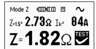
Bild 3.14 Beispiel Ergebnis der Impedanzmessung (detailliert)
