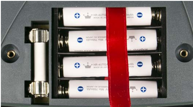
Bild 6.1 Korrekte Polarität der Zellen
